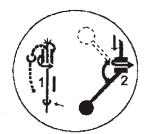
INSERT CABLE THRU CONIC PART OF THE CYLINDER, THE CONIC PART OF THE SMALL PLASTIC SEGMAN SHOULD BE IN FACE WITH THE CONIC PART OF THE WEIGHT. THIS WAY THE SEGMAN WILL INSURE THAT THE WEIGHT STAYS EXACTLY WHERE IT SHOULD AND YOU CAN MAKE YOUR ADJUSTMENT.
